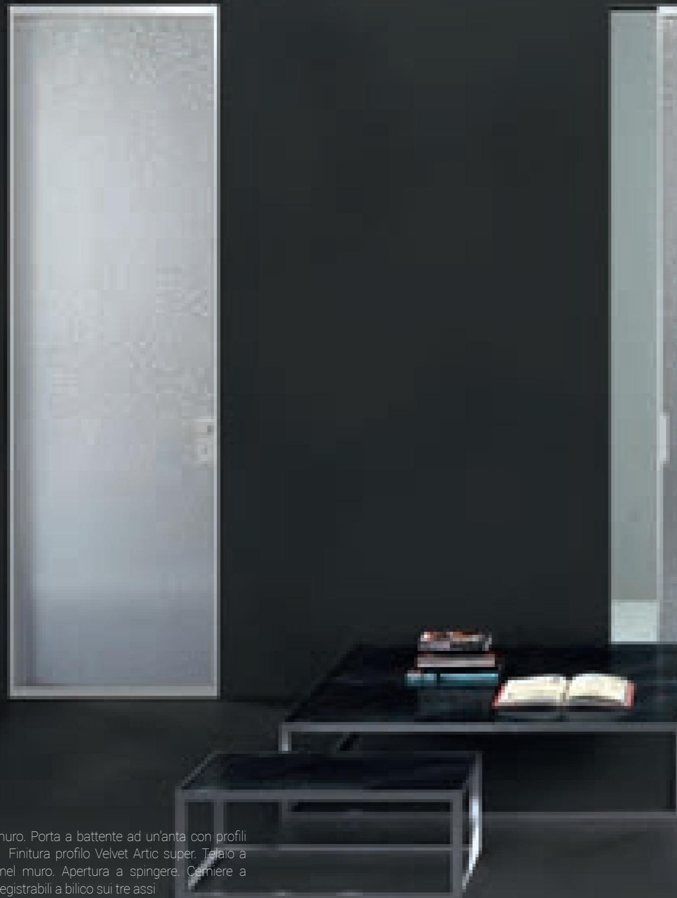
FOS 90 filomuro. Porta a battente ad un'anta con profili a taglio 90°. Finitura profilo Velvet Artic super. Telaio a scomparsa nel muro. Apertura a spingere. Cerniere a scomparsa registrabili a bilico sui tre assi.
